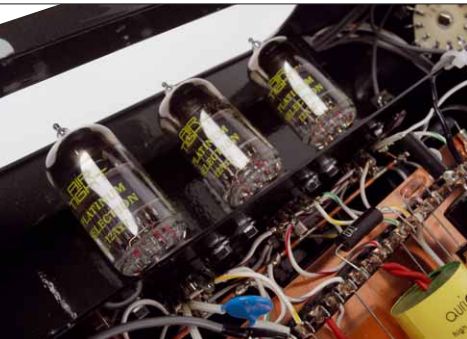
Drei Doppeltrioden bilden das Rückgrat des Phonoteils in der ATC-5
