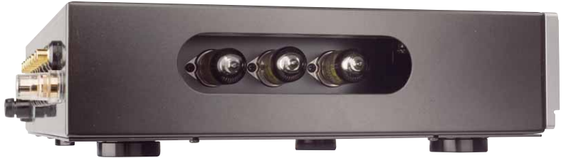
Die Phono-Röhren sind seitlich von außen zugänglich – Marantz lässt grüßen
