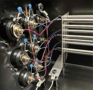
Oben: Der Wahlschalter für den einen Teil der Entzerrungskurve. Er befindet sich genau auf der Höhe der beiden Platinen für den jeweils linken und rechten Kanal. So kann die nicht sichtbare Platine (rückseitig unter der oberen montiert) mit genau den gleichen, möglichst kurzen Kabellängen verbunden werden
