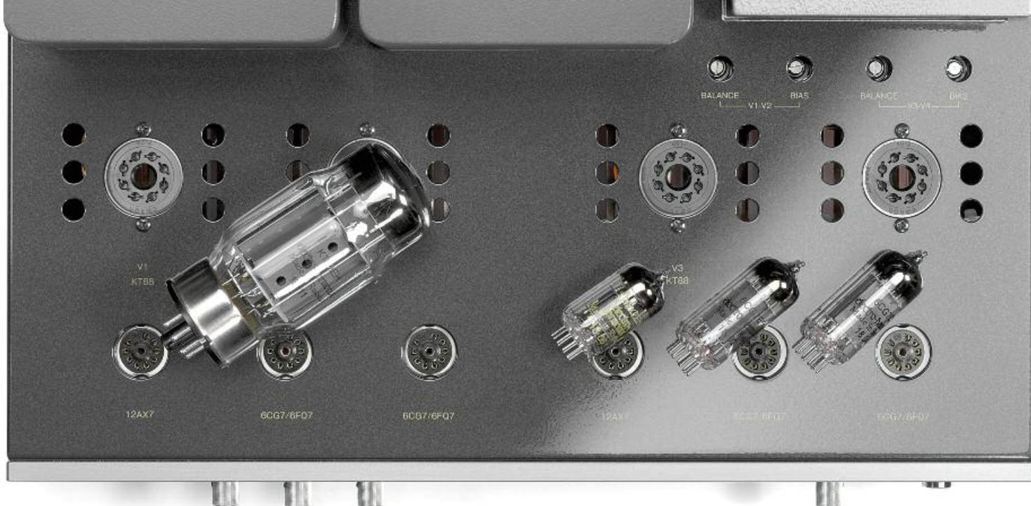
Der gesamte Röhrensatz aus dem Hause Electro Harmonix wird vorgealtert, selektiert und anschließend penibel ausgemessen
