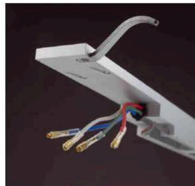
Im flach auslaufenden Profil sind zwei Langlöcher schräg eingefräst – fertig ist das Headshell
