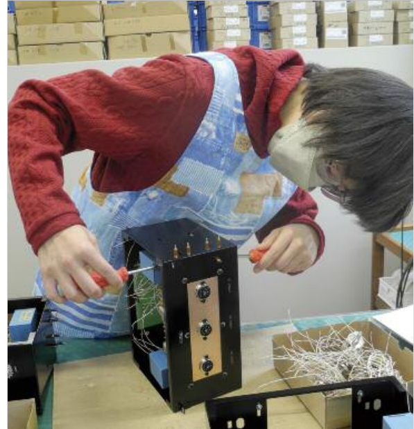
Montage einer geschirmten Vorstufeneinheit mit zusätzlichem Kupferblech an drei AX7-Röhren
