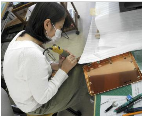
Sorgfältige Entgratung der Reglerdurchlässe bei einer Vollkupfer-Abschirmwanne
