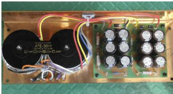
Netzteiltrafos und Kondensatorbänke für die neue Referenz-Phonostufe ATE-3011, montiert auf massivem Kupferblech
