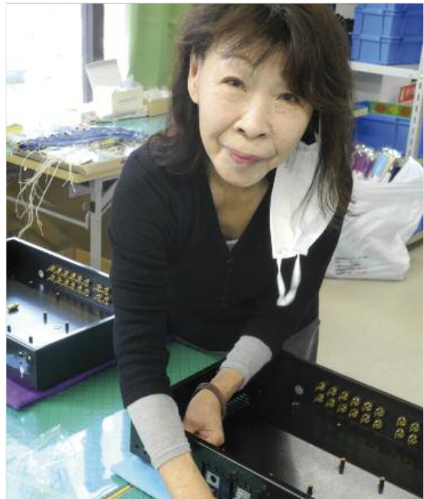
Die langjährigste Mitarbeiterin in der Fertigung schafft hier die Masseverbindungen bei Gehäuse und Erdbuchse
