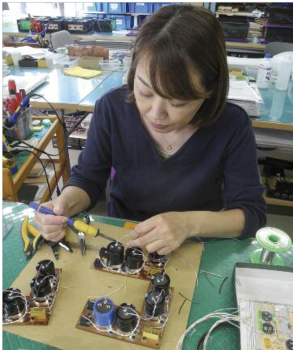
Mit ruhiger Hand: Die Dame verlötet Brücken auf Kondensatoren für ein Netzteil
