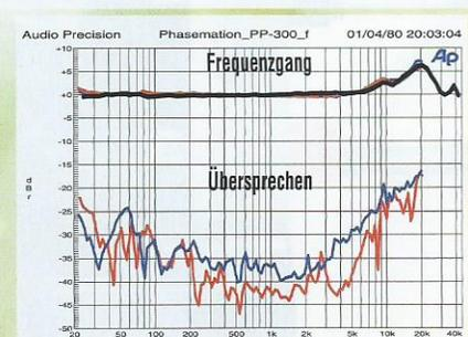
Im Frequenzgang (oben) sieht man eine harmlose Brillanzanhebung und hervorragend geringes, symmetrisches Übersprechen. Überragend gering sind die Abtastverzerrungen (0,036%), die Abtastfähigkeit ist mit 100µm sehr hoch. Eher leises MC (0,65mV), das einen rauscharmen Preamp braucht.
